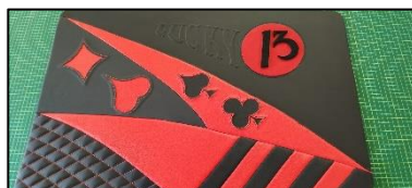
Panneau de porte automobile, assemblage de cuir et d'alcantara, matelassage et gainage
